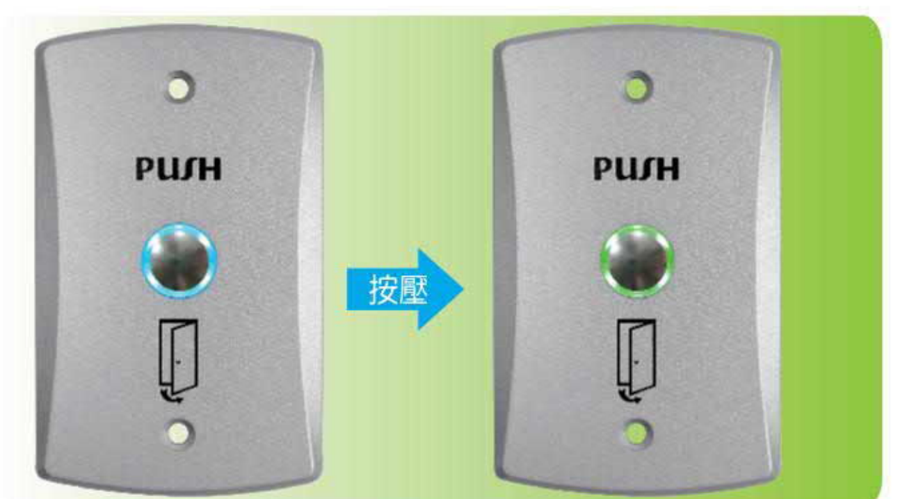
型號:PG-BUTTON-09/BG 尺寸:115(L) x 70(W) x 5(H) (通電時: 藍燈 / 按壓時: 綠燈) 接點: N.O. / N.C. / COM.
