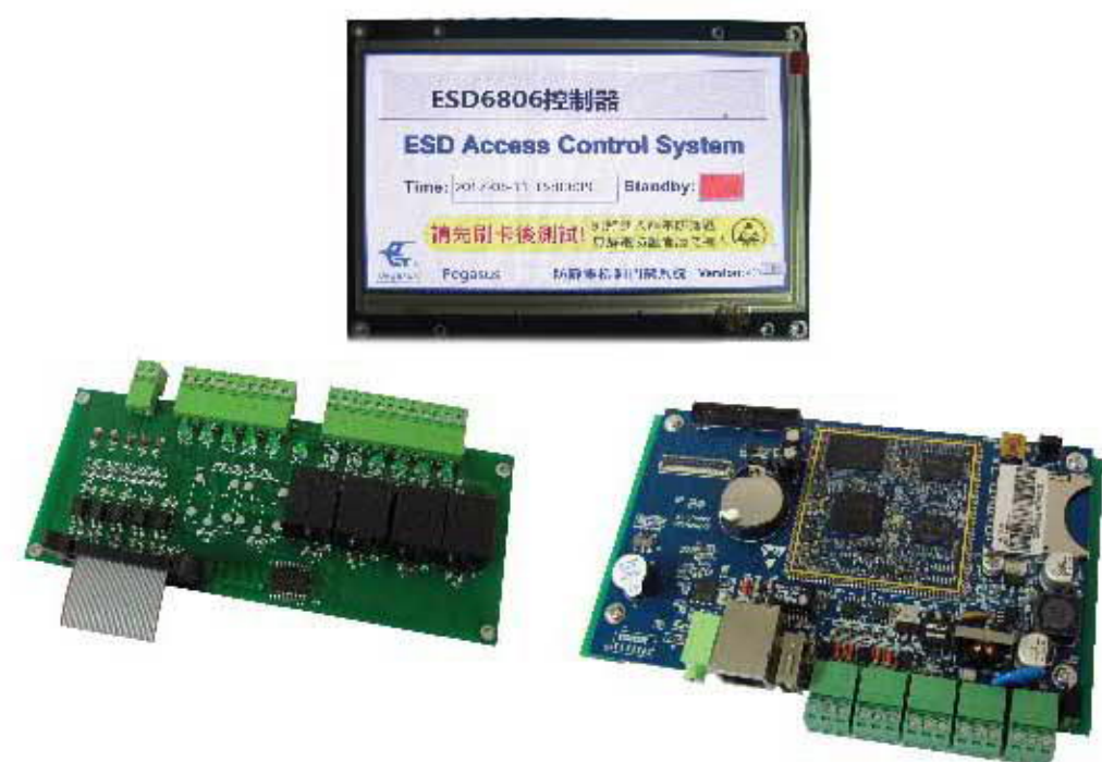
控制器 7吋彩色螢幕+ESD許可權控制器+繼電器板) PP-6806/ESD
